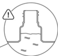
Die Tülle zum Schluss mit einer Drehbewegung nach unten drücken, sodass sie vollständig in der Matratze einsinkt.
