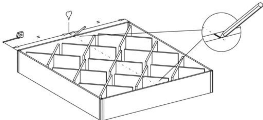
**Schritt 6.** Positionieren Sie die 2 Bodenplatten gegen den in Schritt 5 gezeichneten Mittelstrich. Wenn Sie nur eine Platte haben (bei einem Einzelbett), sorgen Sie dafür, dass die Platte rund herum ca. 12 cm über die Leisten hängt.
