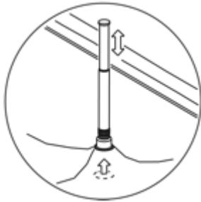
Anschließend den Conditioner dazugeben. Danach den Stöpsel und Schraubverschluss wieder anbringen und die Fülltülle wieder in die Wassermatratze drücken.
