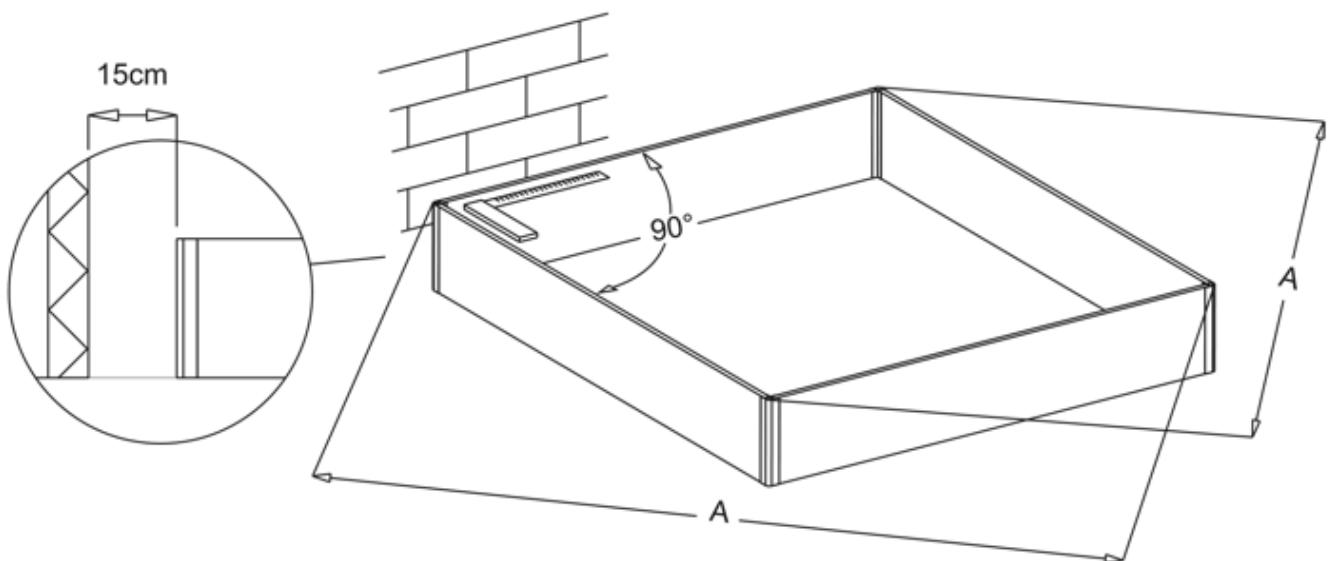
**⚠** Platzieren Sie die Leisten sorgfältig im rechten Winkel, überprüfen Sie dies, indem Sie dafür sorgen, dass die beiden Übereck-Maße A gleich sind.
