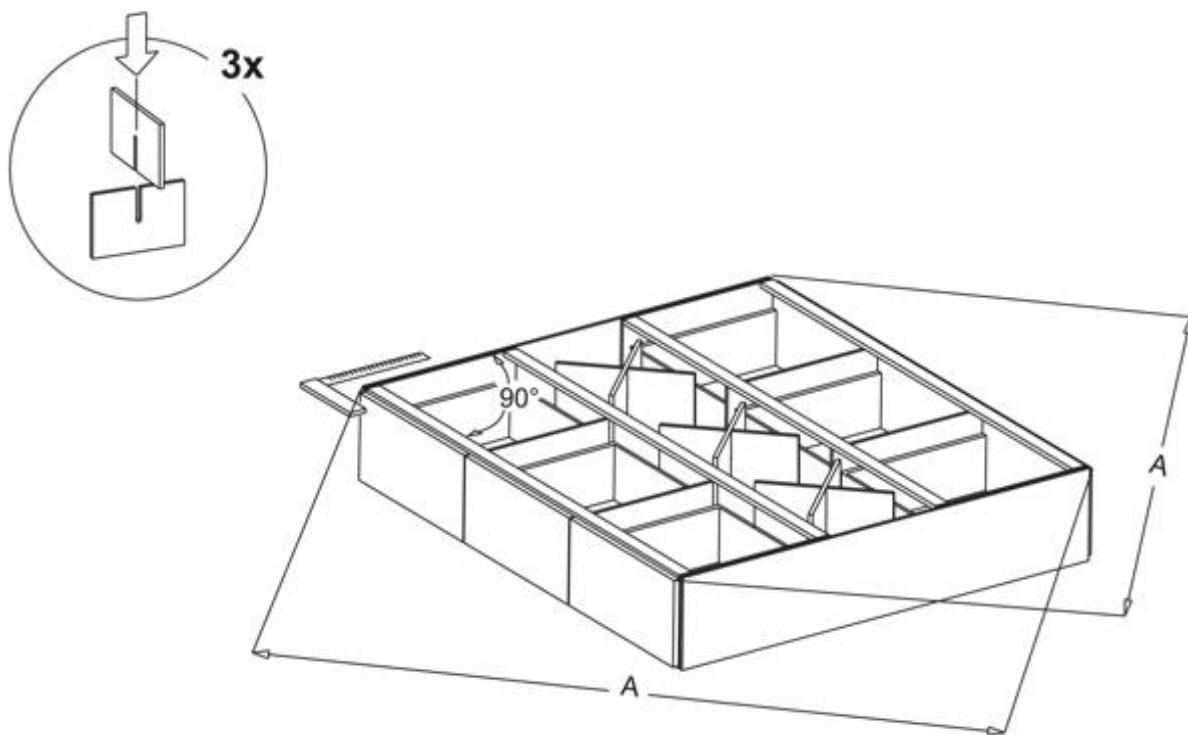
**⚠** Platzieren Sie das Podest sorgfältig im rechten Winkel, überprüfen Sie dies, indem Sie darauf achten, dass die beiden Übereckmaße A gleich sind.
