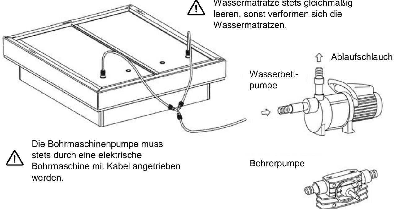
**⚠** Die Bohrmaschinenpumpe muss stets durch eine elektrische Bohrmaschine mit Kabel angetrieben werden.
