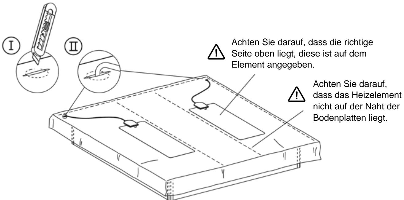
**⚠** Den Thermostat entfernen (**Achtung:** nicht bei jeder Heizung kann der Thermostat entfernt werden), um anschließend das Kabel durch das Loch führen zu können. Erst nach dem Füllen den Thermostat wieder aufsetzen
